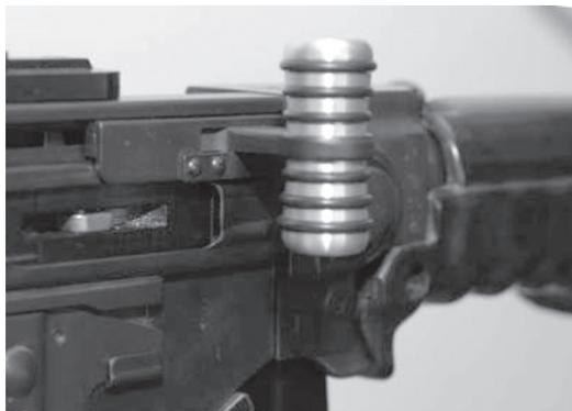
*Bild 20: Poignée de charge anatomique pour F ass 57*
