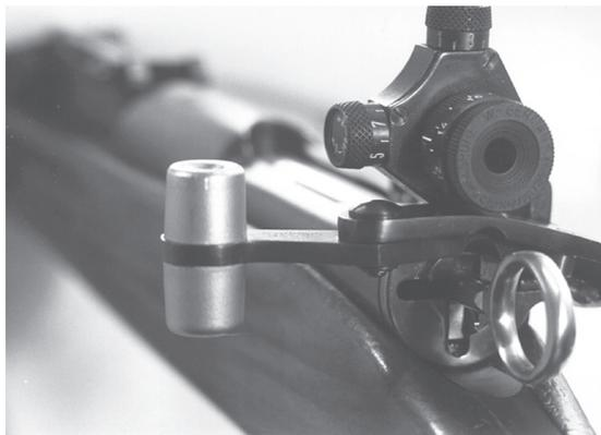
Figure 23: Verrou à gauche pour mousqueton 31
