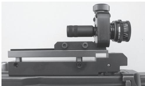
Figure 13: Porte dioptre pour F ass 57 pour le montage de dioptres à l'épreuve des vibrations de tir produits divers
